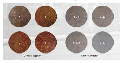
Степени очистки проверяется путем визуального сравнения. Соответствие применяемых стандартов и норм:
